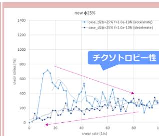
せん断速度とせん断応力 (解析結果)
