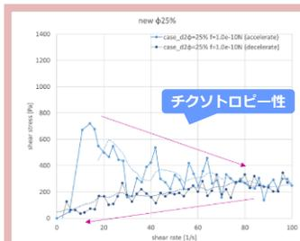
せん断速度とせん断応力 (解析結果)
