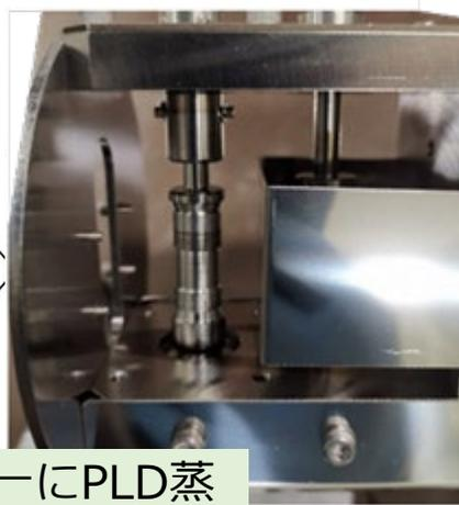
管形状試料の外周に均一にPLD蒸着できるように試料ホルダを作製
