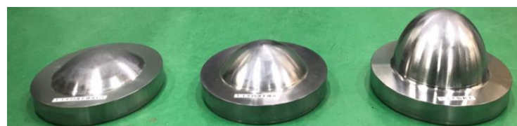
床接触球殻座屈試験 形状: JSFR原子炉容器模擬
