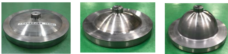
構造不連続部付き球殻座屈試験 形状: もんじゅ原子炉容器模擬
