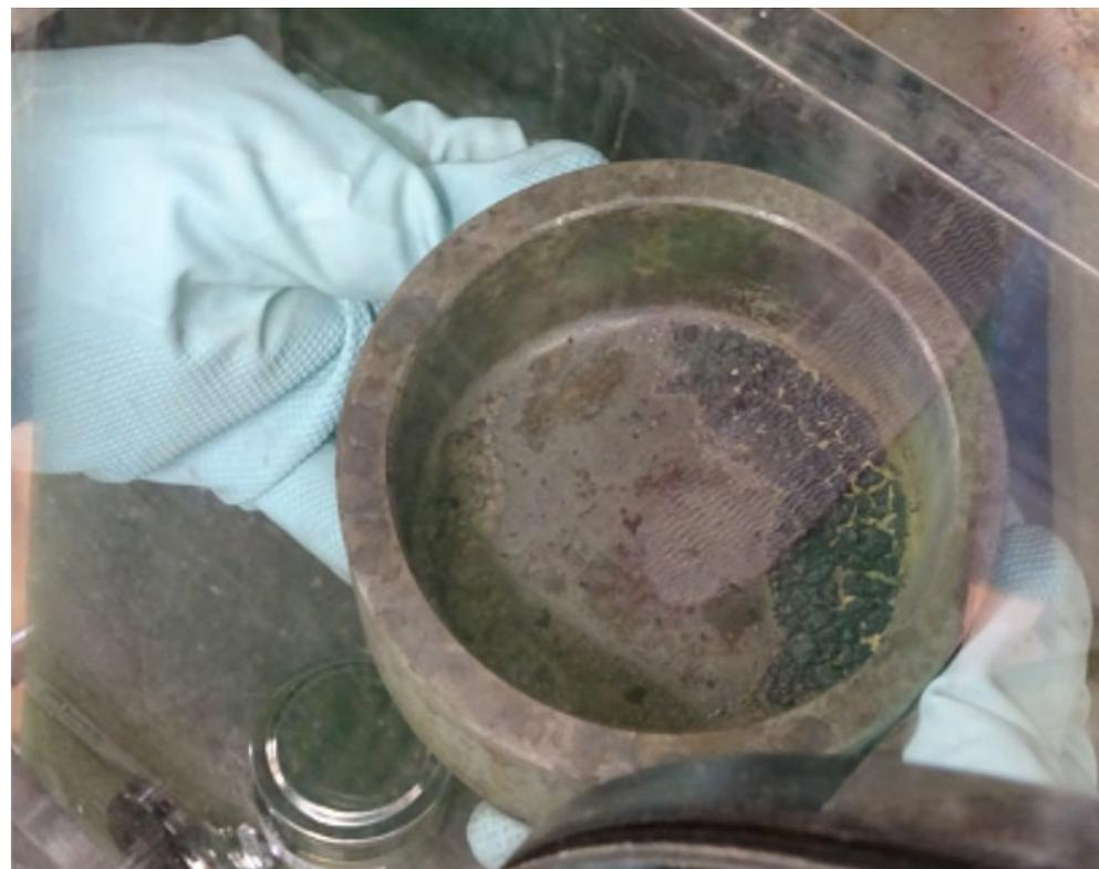
脱硝・転換後のMA含有MOX燃料粉末の外観
