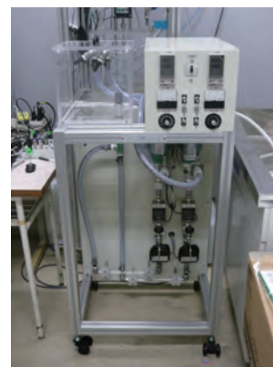
図1 ポンプ診断実験設備
