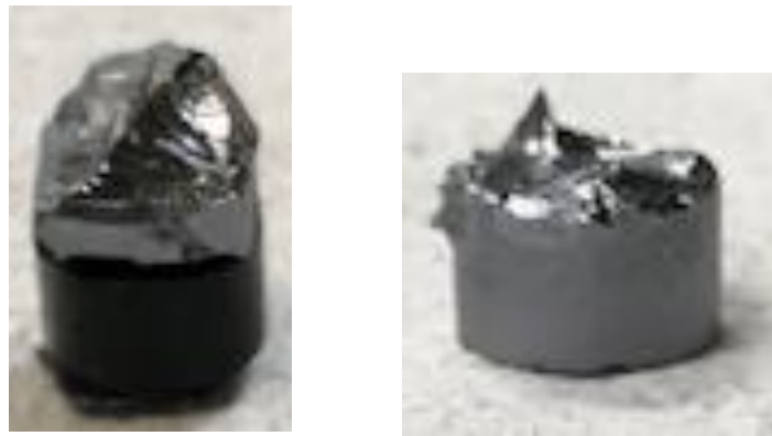
図 3.2-18 成形体に直接金属 Si を接触させる反応焼結法で作製した試料 (成形体径 ; 10 mm φ) の外観 (左 : 反応焼結前、右 : 反応焼結後)
