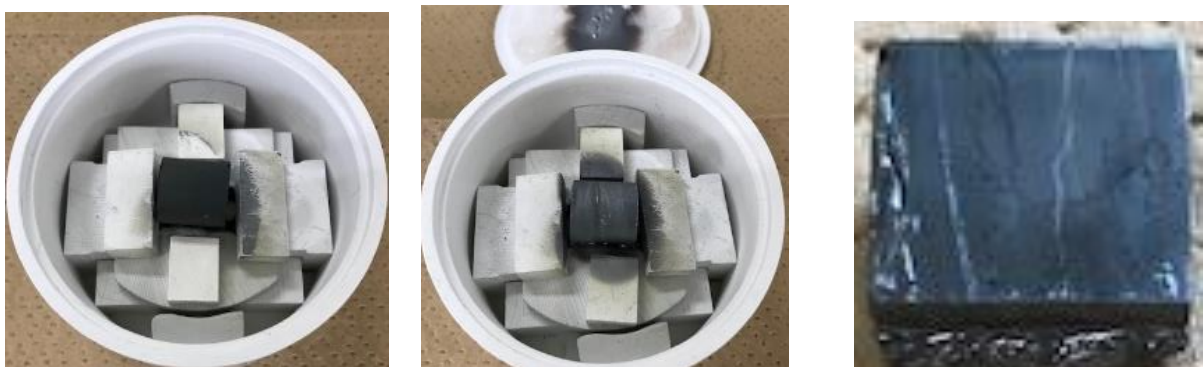
図 3.2-16 PVA による造粒粉を用いて作製した成形体（図左）の反応焼結体の外観（図中央）および円柱軸方向に切断した切断面（図右）
