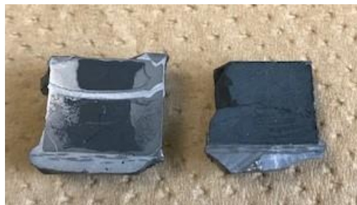
図 3.2-10 方法 A で反応焼結した試料の切断面 (左：一軸成形体の反応焼結試料、右：CIP 成形体の反応焼結試料)
