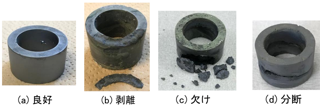
図 3.2-27 反応焼結により得られた円筒形状 SiC 焼結体の外観
