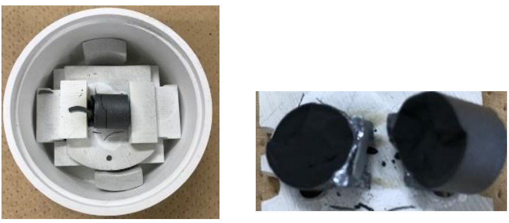
図 3.2-12 方法 B で反応焼結した試料（一軸成形体の反応焼結試料）の外観と破断面
