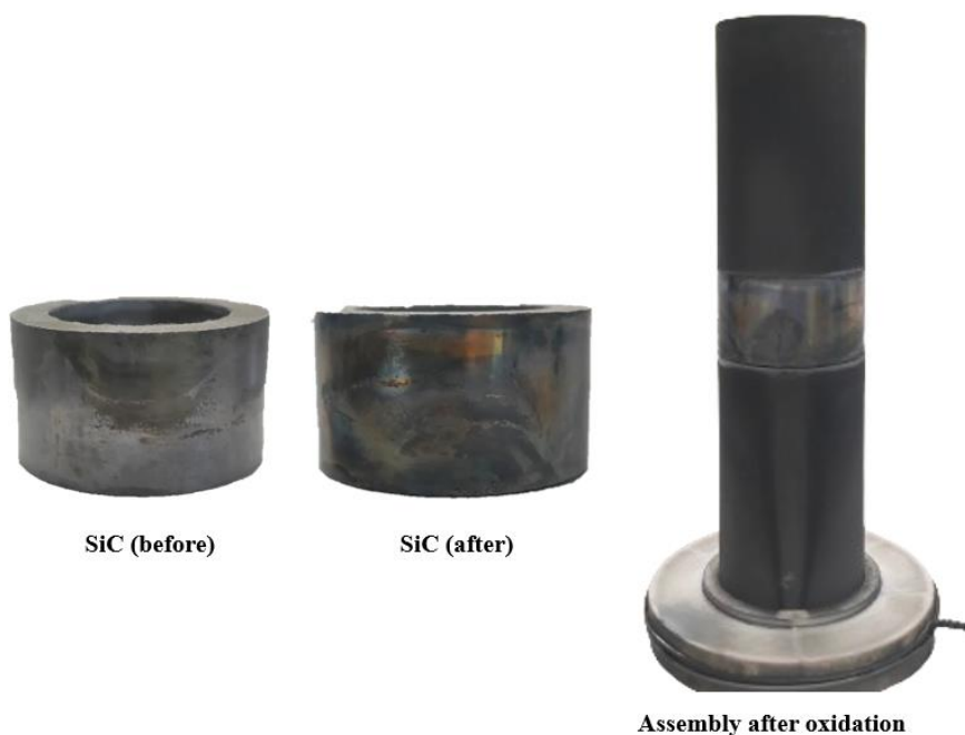
図 3.1-14 RS-SiC②酸化実験前後の試験片写真 (1300°C/1000ppm)
