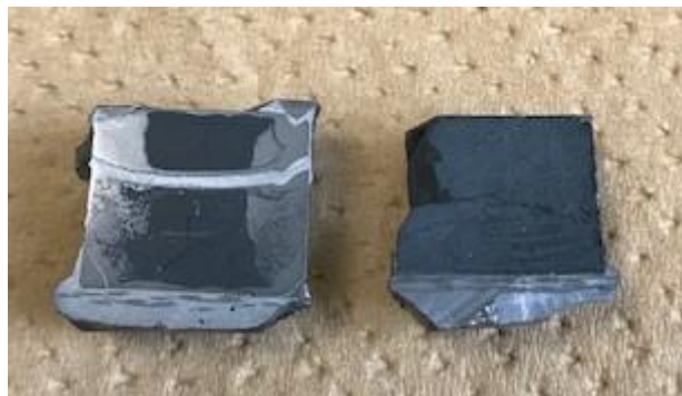
図 3.2-6 反応焼結後の試料を縦方向に切断した面の写真 (左：一軸加圧成形体の反応焼結体、右：CIP 成形体の反応焼結体)
