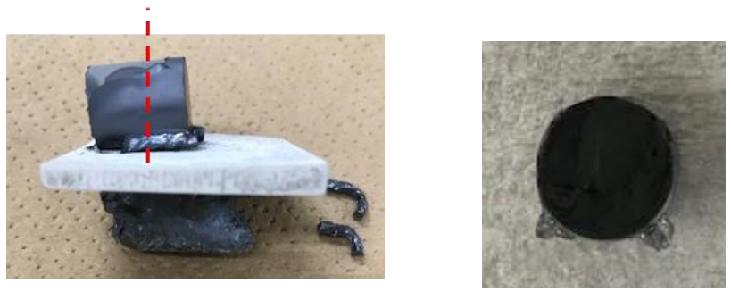
図 3.2-13 方法 B で反応焼結した試料（CIP 成形体の反応焼結試料）の外観と切断面
