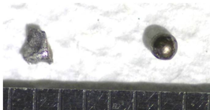
図 3.3.1-19 U_{0.66}Fe_{0.34} 試料の外観 (左：溶融前 右：溶融後)
