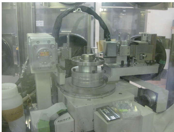
図 3.1-2 グローブボックス内に設置した XRD 回折析装置の外観
