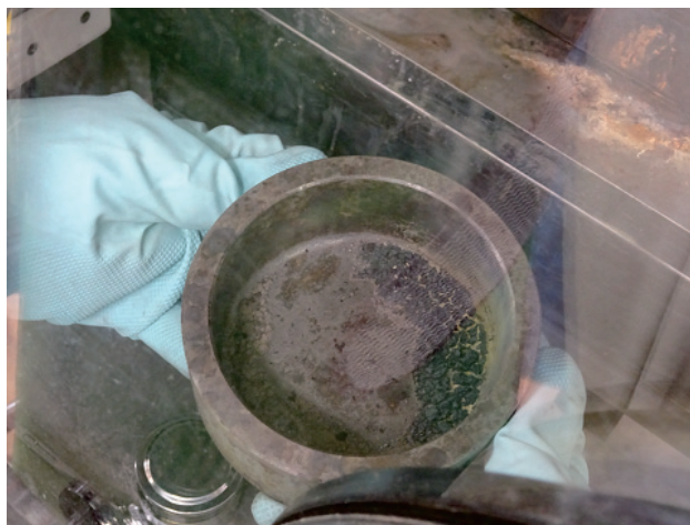
図 3.1-1 脱硝・転換後の MA 含有 MOX 燃料粉末の外観
