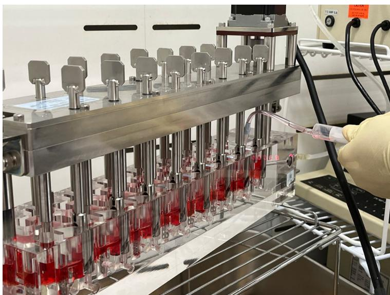
図 3.5-1 多段式ミキサセトラに染料を加えた有機相を流している様子
